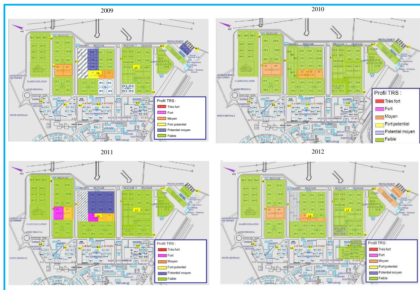
Figure 95 : Hiérarchisation des ouvrages de l'aération selon les concentrations en TRS en 2009, 2010, 2011 et 2012
