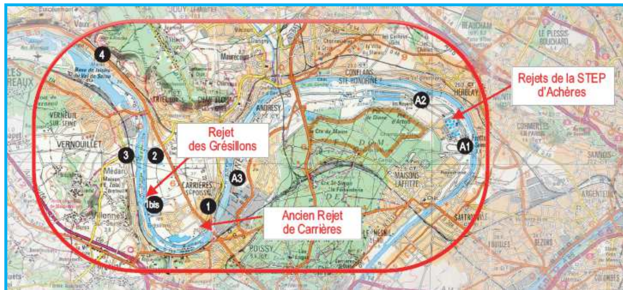
Figure 34 : Localisation des stations de suivi de la qualité de la Seine au droit des rejets de Seine Aval et Seine Grésillons
